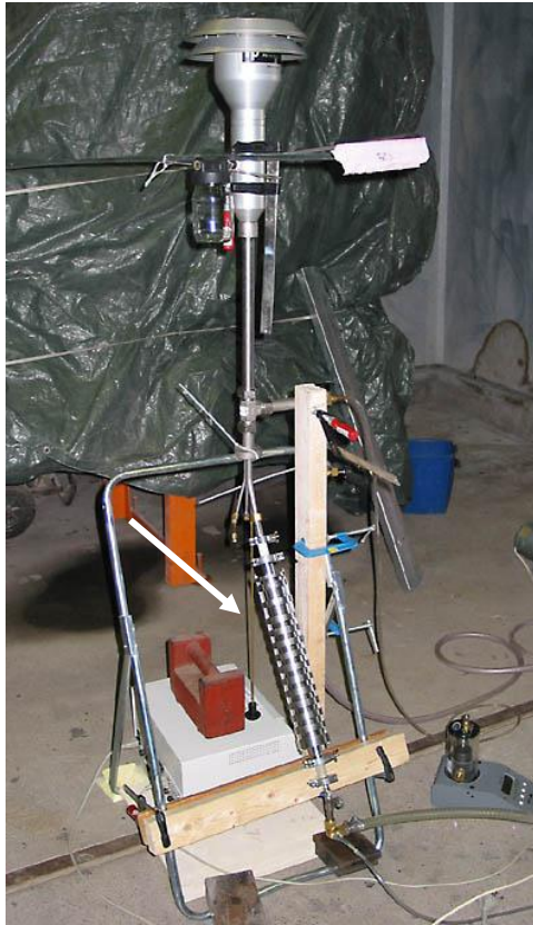
Figur 6 En 12-steps kaskadimpaktorn (vid pilen) kopplad till APS-instrumentets PM_{10} -intag.
